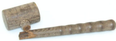
Bsp./Abb.1 gebrochener Ferrozellgriff nach Sprödbruch
